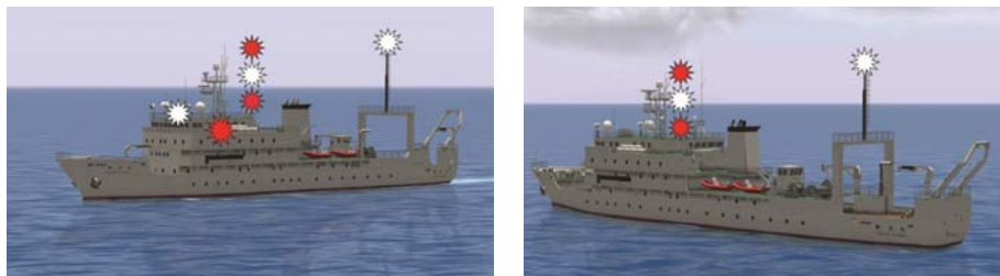
Figure 120 : navire à capacité de manœuvre restreinte > à 50 m avec erre
