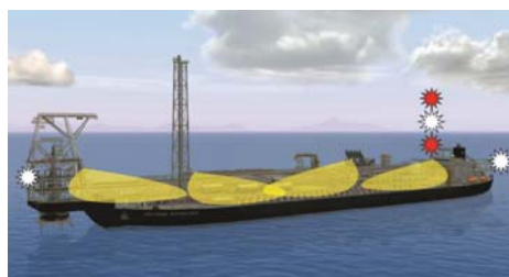
Figure 126 : navire à capacité de manœuvre restreinte > à 100 m au mouillage
