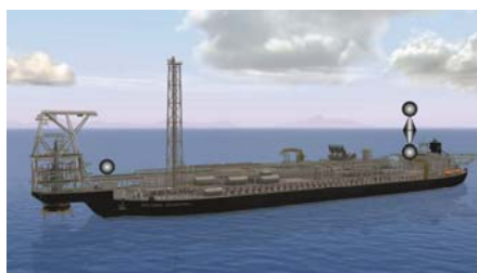
Figure 127 : marques de jour d'un navire à capacité de manœuvre restreinte au mouillage
