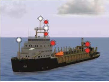
Figure 133 : navire à capacité de manœuvre restreinte avec erre > à 100 m en train de draguer ; obstruction sur bâbord
