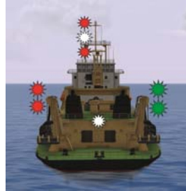
Figure 133 : navire à capacité de manœuvre restreinte avec erre > à 100 m en train de draguer ; obstruction sur bâbord
