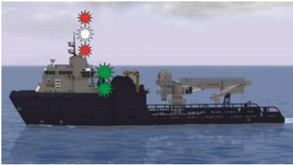
Figure 134 : navire à capacité de manœuvre restreinte < à 100 m sans erre ou au mouillage ; en train de draguer ou en opérations sous-marines, bord bâbord libre.
