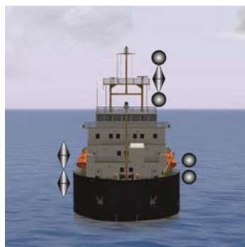
Figure 132 : navire à capacité de manœuvre restreinte avec erre > à 100 m en train de draguer ; obstruction sur bâbord
