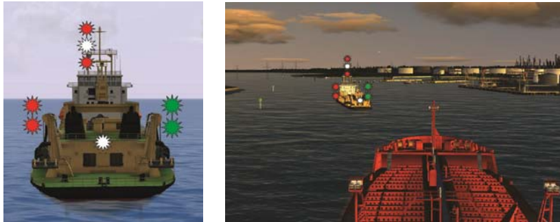
Figure 133 : drague en opération, son côté bâbord obstrué ; passer sur son tribord
