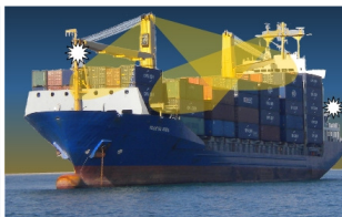
Figure 35 : Feux de mouillage pour un navire > 100m (photo Hervé Baudu)
