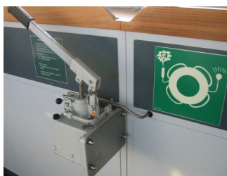
Figure 2 : Déclencheur à distance de la mise à l'eau de la bouée couronne (photo Hervé Baudu)
